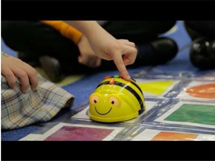
Bee-Bot ist ein kleiner, sehr einfacher, programmierbarer Roboter für Kinder der Unterstufe. Er ist für den Zyklus 1 geeignet. Mit seinen sieben Tasten kann man ihn so programmieren, dass er einfache Bewegungsabläufe ausführt.
